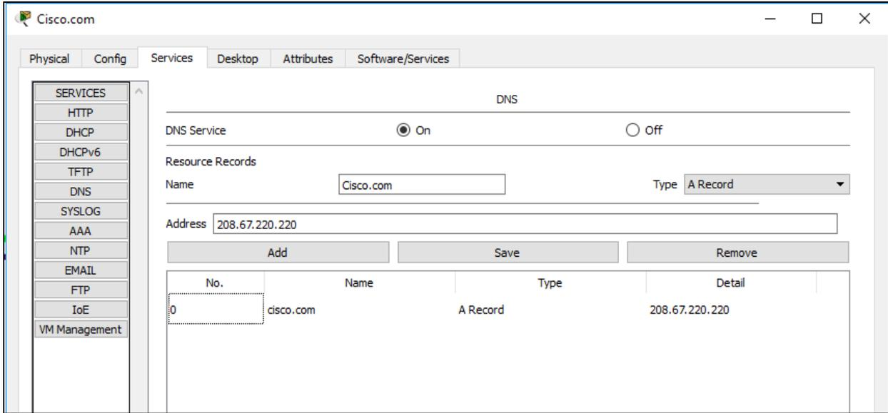
c. Configure los ajustes generales del servidor Cisco.com.
